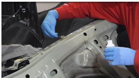
Figura 126 – Aplicación del Tratamiento de Superficies. Fuente: CESVISMAP
