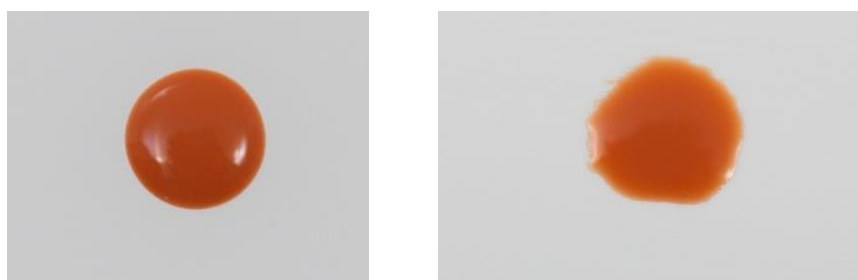
Figura 90 - Sustrato contaminado (mala humectación), Sustrato limpio (buena humectación). Fuente: CESVIMAP
