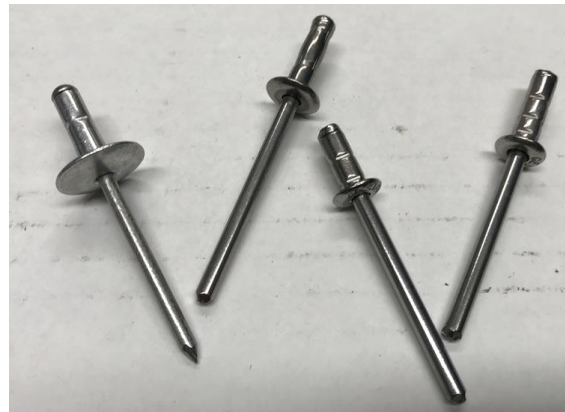
Figura 109 - Una variedad de geometrías de remaches ciegos con diferentes tamaños de cabeza, longitudes de cuerpo de remache, diámetros de mandril y de cuerpo y puntos de plegado dentro del cuerpo del remache. Fuente: TWI
