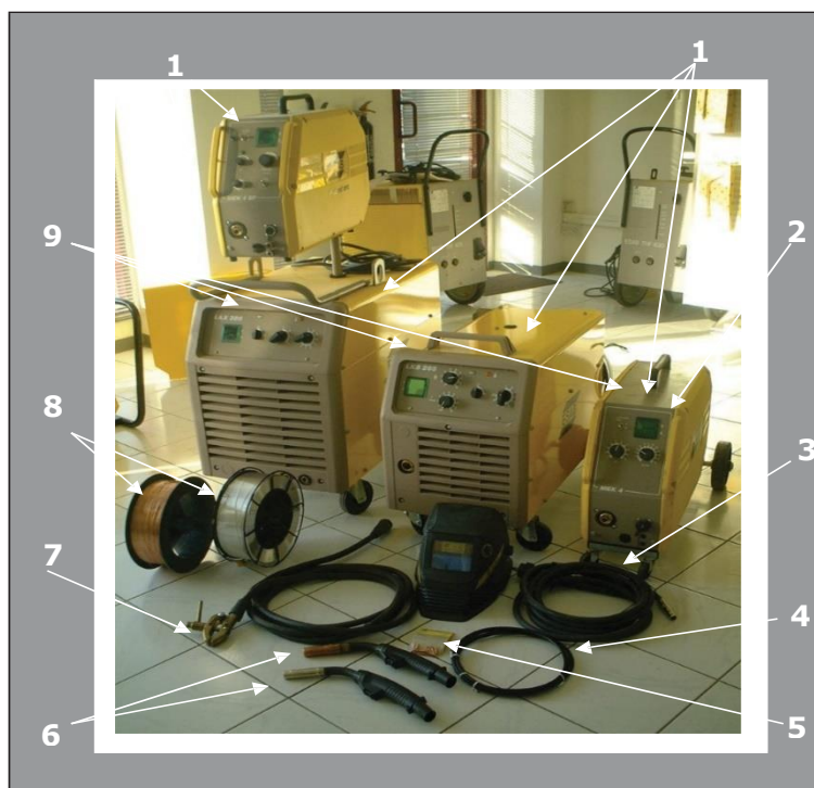
Figura 12 -Transformador/rectificador de la fuente de alimentación (tipo de voltaje constante); 2. Fuente de alimentación del inversor; 3. Conjunto de manguera de alimentación (revestimiento, cable de alimentación, manguera de agua, manguera de gas); 4 revestimientos; 5 puntas de contacto de repuesto; 6 Conjunto del cabezal de la antorcha; 7 Cable de
