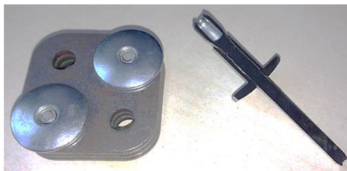
Figura 106 - Remaches ciegos colocados en una pila de material de 3 chapas y una sección transversal de remache. Fuente: TWI
