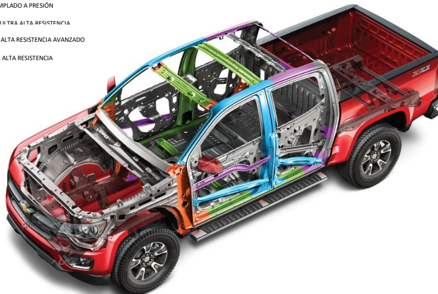
Figura 9 Estructura de la carrocería del Chevrolet Colorado. Fuente: https://media.gm.com/media/us/en/gm/news.detail.html/content/Pages/news/us/en/2014/mar/0311-colorado.html
