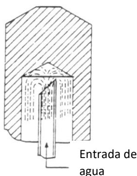
Figura 61 - Disposición para la refrigeración por agua del electrodo. Fuente: TWI
