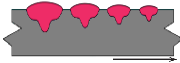
Figura 31 - El efecto del aumento de la velocidad de desplazamiento. Fuente: TWI
